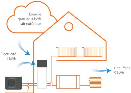
Pour 1 kWh d'électricité consommée, la pompe à chaleur va restituer jusqu'à 5 kWh de chaleur selon les conditions et le type de logement.
